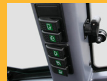
Zusammengefasste Schalterleiste, Steckdose mit Dauerstrom
