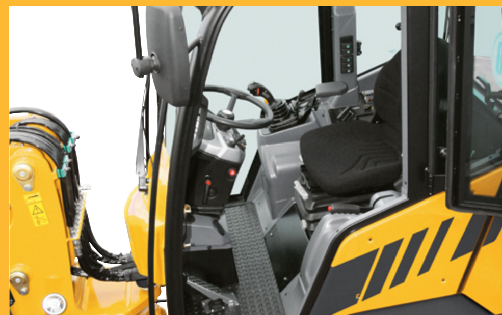
Zusammengefasste Schalterleiste, Steckdose mit Dauerstrom
