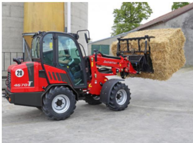
Hinsichtlich der technischen Details brauchen sich die kompakten Teleradlader von Schäffer nicht vor den größeren Baureihen verstecken. Verschleiß- und wartungsfreie Ferro-Form Gleitelemente im Teleskoparm sorgen zusammen mit den 7 t Schwerlastachsen über Jahre für einen problemlosen Ladebetrieb. Das Knick-/Pendelgelenk ist ebenso wartungsfrei wie die Lamellenbremse im Ölbad.
