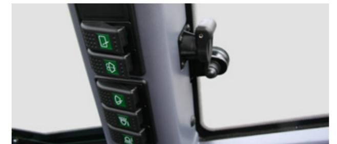
Zusammengefasste Schalterleiste, Steckdose mit Dauerstrom
