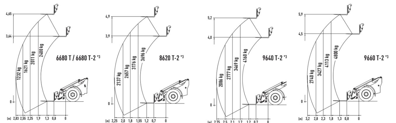
\*1 Hubgerüst horizontal, eingefahren, mit Palettengabel (nach ISO 14397) \*2 nach ISO 8041 \*3 Nutzlastdiagramm. Einsatz mit Gabelzinken auf festem, ebenen Untergrund (nach EN 474-3)
