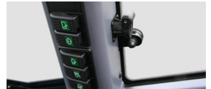
Zusammengefasste Schalterleiste, Steckdose mit Dauerstrom
