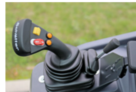
Joystick mit erweitertem Funktionsumfang
