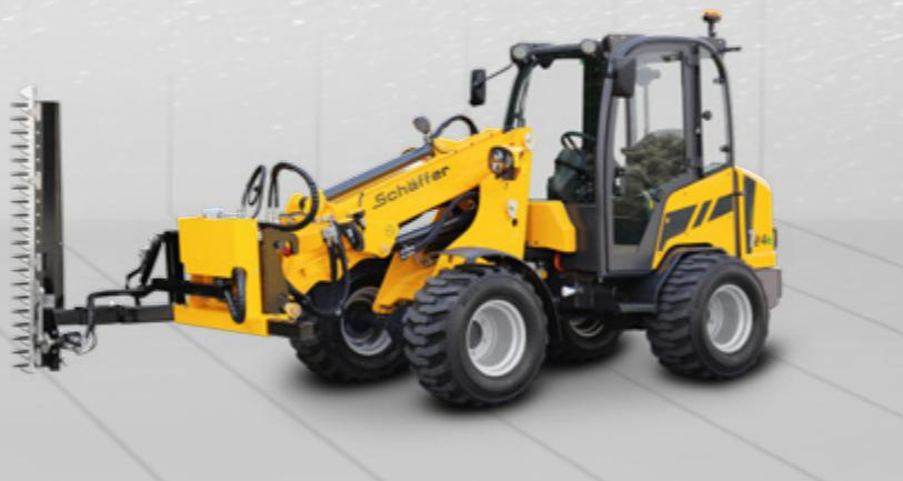
technisch auf dem Radlader 24e. Dank Teleskoparm besitzt der 24e T eine Hubhöhe von 3,72 m, er ist wahlweise mit Fahrerschutzdach oder Kabine erhältlich und bietet eine Kipplast mit Palettengabel von 1,3 t bei einem Gewicht von 2,8 t. Das Knickgelenk macht die Maschine besonders wendig, der Innenradius beträgt nur 1,15 m. Je nach Bereifung misst der 24e T zwischen 1,41 m und 1,59 m in der Breite bei einer Höhe von 2,19 m mit Fahrerschutzdach bzw. 2,14 m mit Kabine.
