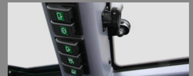
Zusammengefasste Schalterleiste, Steckdose mit Dauerstrom
