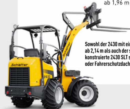
Sowohl der 2430 mit einer Bauhöhe ab 2,14 m als auch der sehr niedrig konstruierte 2430 SLT sind mit Kabine oder Fahrerschutzdach erhältlich.
