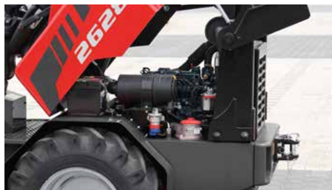
Die Motorhaube kann nach vorn geöffnet werden. Somit sind alle Servicestellen von beiden Maschinenseiten aus leicht zugänglich.
