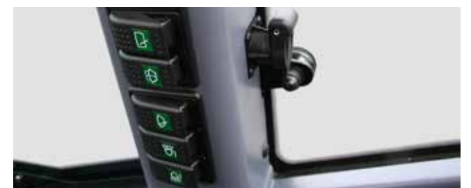
Zusammengefasste Schalterleiste, Steckdose mit Dauerstrom
