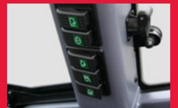
Zusammengefasste Schalterleiste, Steckdose mit Dauerstrom
