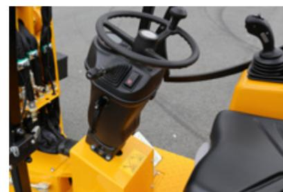
La colonne de direction est réglable. En plus d'être commode, cela facilite la montée et la descente.
