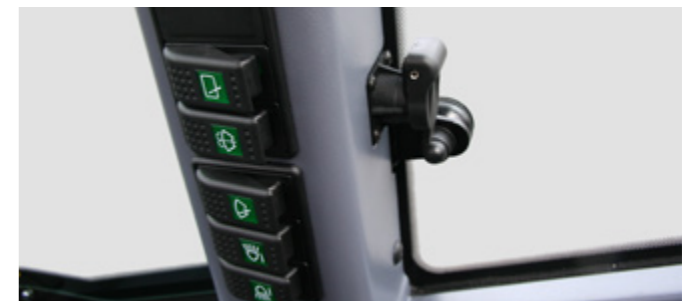
Zusammengefasste Schalterleiste, Steckdose mit Dauerstrom
