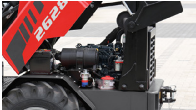
Die Motorhaube kann nach vorn geöffnet werden. Somit sind alle Servicestellen von beiden Maschinenseiten aus leicht zugänglich.
