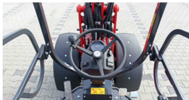
L'ergonomie de la chargeuse est remarquable. L'opérateur dispose d'une place spacieuse malgré les dimensions compactes de la machine. La bonne disposition du Joystick et du volant réglable lui permet de travailler avec un grand confort.
