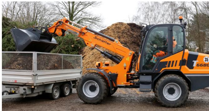
Une tâche typique pour la chargeuse télescopique : avec sa hauteur de levage de 4,95 m au niveau de l'axe de pivotement de l'outil, il est possible de charger sans difficulté les remorques et les camions les plus hauts.
