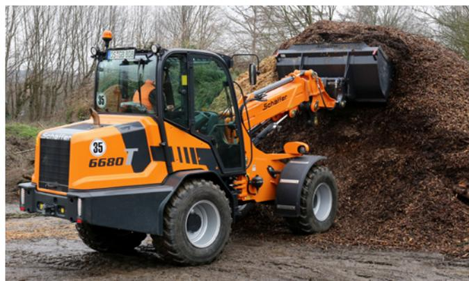
Comparativement à la chargeuse sur pneus classique, la portée d'une chargeuse télescopique est beaucoup plus grande. Cela permet par exemple de repousser le BRF en hauteur de manière à gagner de la place.
