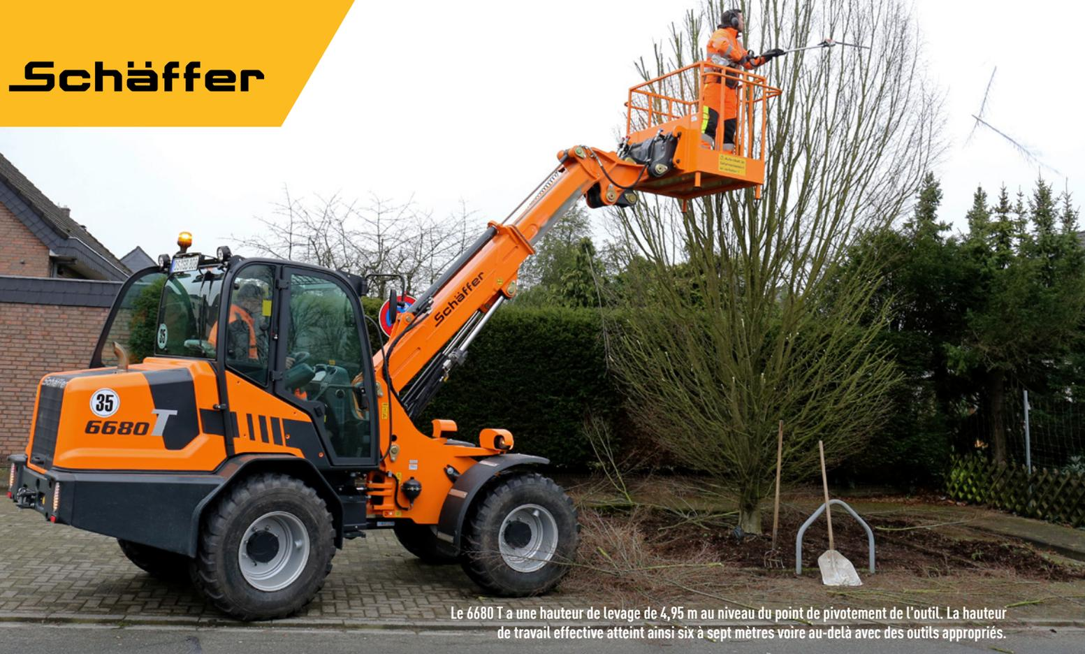
Le 6680 T a une hauteur de levage de 4,95 m au niveau du point de pivotement de l'outil. La hauteur de travail effective atteint ainsi six à sept mètres voire au-delà avec des outils appropriés.
