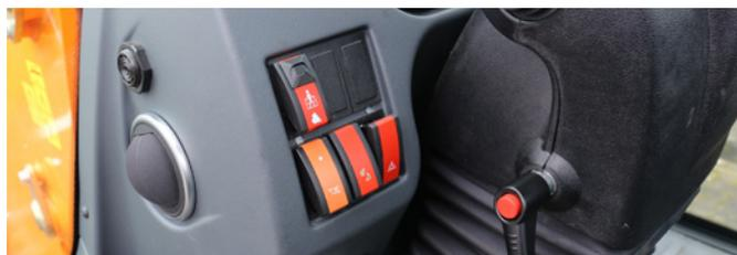
En actionnant l'interrupteur à bascule situé dans le coin supérieur gauche, la chargeuse passe en mode « nacelle », et certaines fonctions de sécurité sont activées.
