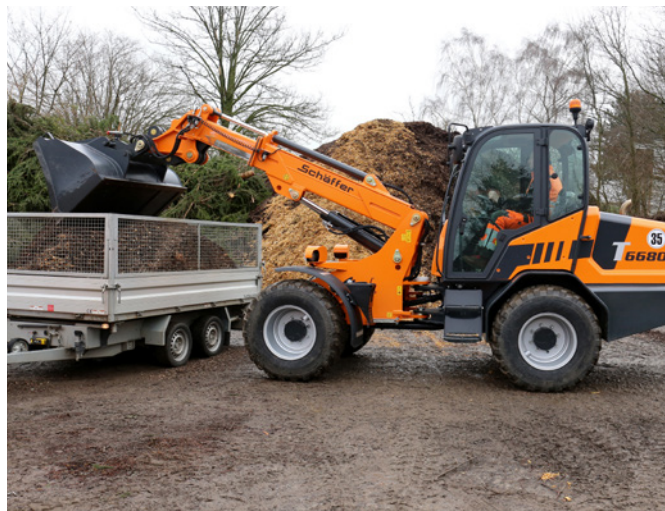
Eine typische Aufgabe für den Teleradlader: Mit einer Hubhöhe von 4,95 m am Werkzeughöhepunkt lassen sich auch größere Anhänger und LKW problemlos beladen.
