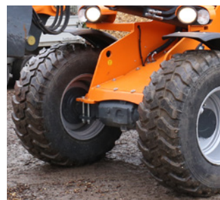
Das MPT-Profil der 20 Zoll-Bereifung sorgt für ausreichend Grip sowohl auf Asphalt, als auch auf matschigem Untergrund.
