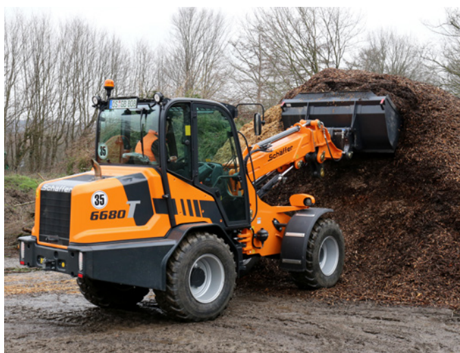
Im Gegensatz zum klassischen Radlader besitzt der Teleradlader eine deutlich größere Reichweite. So lassen sich zum Beispiel Hackschnitzel platzsparend aufschieben.
